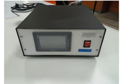
ماژول التراسونیک - منبع تغذیه و ترانسدیوسر
